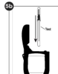
**5b. SystemSURE Plus®:** Insira o dispositivo de detecção e pressione **OK** para iniciar a medição.
